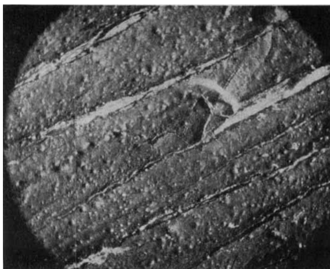
Abb. 2. Chromgrün in Chlorkautschuklack auf Sperrholz nach einjähriger Bewitterung. Abplatzen entlang der Poren.
